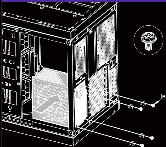
Acesse o suporte da Fonte de alimentação através da lateral direita do gabinete, posicione a fonte com as furações alinhadas com as do gabinete, e então fixe-a com os respectivos parafusos.
