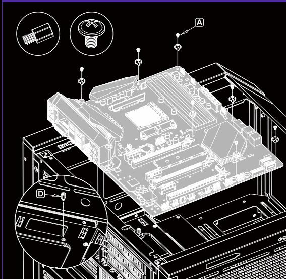
Posicione a Placa-Mãe com as furações alinhadas com as do gabinete, de acordo com o formato da Placa-Mãe. Encaixe o painel I/O na parte traseira do gabinete, e fixe a Placa-Mãe com os respectivos parafusos.
