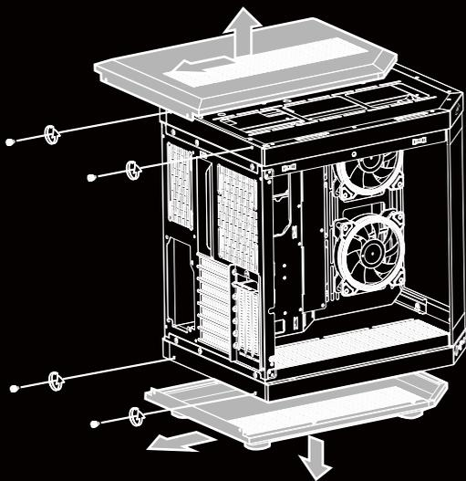
Para remover o painel superior e inferior, primeiramente remova os parafusos localizados na parte traseira, e então aplique uma leve força na direção indicada na imagem ao lado.
