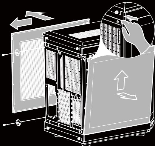
Para remover os painéis laterais, remova os parafusos traseiros. Em seguida aplique uma leve força na direção indicada na imagem ao lado.
