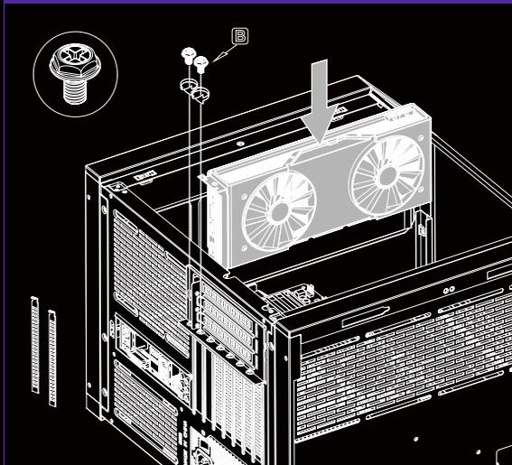
Identifique quantos slots de expansão a Placa de Vídeo irá utilizar. Remova os slots de expansão e fixe a Placa de Vídeo na Placa-Mãe.
