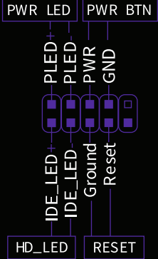
Conector Power/Reset/LED da Placa-Mãe
