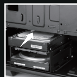
Fixe o HDD com parafusos
