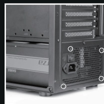
Fixe a PSU com parafusos
