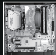
Fixe a placa mãe com parafusos
