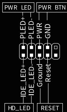
Conector Power/Reset/LED da Placa-Mãe
