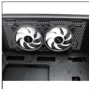
Ponha as ventoinhas de 12cm ou de 14cm (ajuste para que possam ventilar para fora do gabinete e alinhe com a posição dos encaixes dos parafusos)
