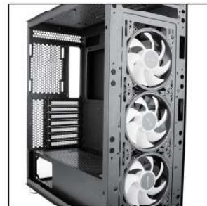
Fixe os parafusos na parte interna do painel frontal para fixar a fan (prenda os parafusos nos orifícios na parte inferior)
