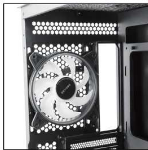
Ponha a ventoinha de 12cm ou de 14cm (ajuste para que possa ventilar para fora do gabinete e alinhe com a posição dos encaixes dos parafusos)
