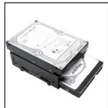
Encaixe o HDD e fixe-o com parafusos
