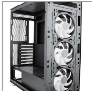
Ponha as ventoinhas de 12cm ou de 14cm (ajuste para que possa ventilar a parte interna e alinhe com a posição dos encaixes das ventoinhas)
