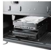
Alinhe a cápsula aos buracos dos parafusos na parte inferior. Insira a cápsula
