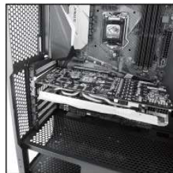
Insira a placa alinhada aos buracos dos parafusos
