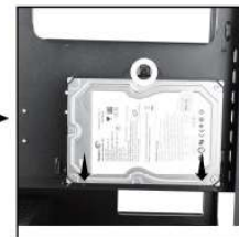
Fixe o encaixe com o HDD instalado na posição indicada
