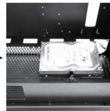
Fixe e instale na cápsula da fonte
