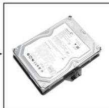
Posicione o HDD alinhado aos encaixes dos parafusos
