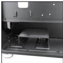
Posição da cápsula do HDD quando instalado
