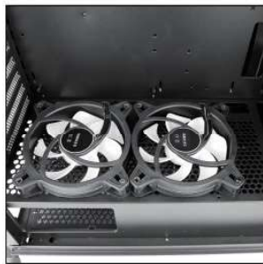
Posicione as ventoinhas de 12cm a fim de que possam ventilar para cima e alinhe com a posição dos encaixes dos parafusos)
