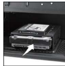
Alinhe a cápsula aos buracos dos parafusos na parte inferior. Insira a cápsula
