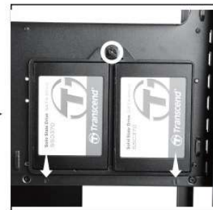
Fixe o encaixe com o SSD instalado em sua posição devida
