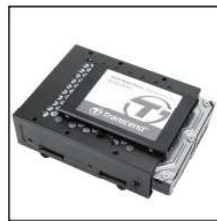
Encaixe o SSD e fixe com parafusos
