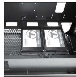
Fixe o encaixe na cápsula da fonte com o SSD já instalado
