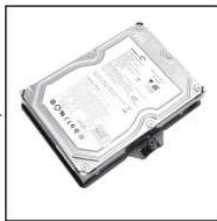
Insira o HDD no encaixe e alinhe com os parafusos
