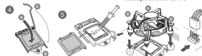
Depois que a placa de carga estiver sob o parafuso, pressione a alavanca do soquete.
