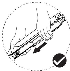
**Braço superior:** Remova a presilha de gerenciamento de cabos deslizando-a para baixo.
