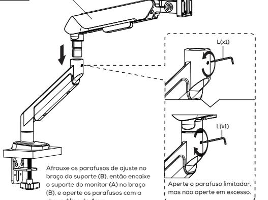
Afrouxe os parafusos de ajuste no braço do suporte (B), então encaixe o suporte do monitor (A) no braço (B), e aperte os parafusos com a chave Allen de 4mm.
