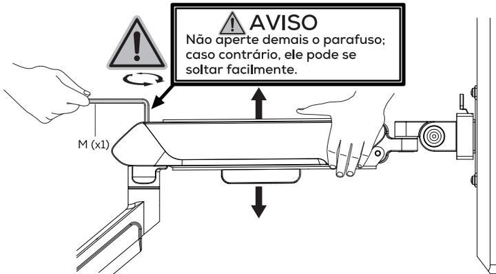
Para balancear corretamente o braço com o monitor montado, ajuste a tensão da mola usando a chave Allen fornecida da seguinte forma:
