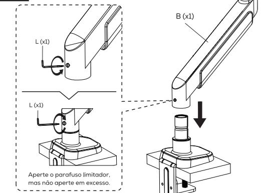
Aperte o parafuso limitador, mas não aperte em excesso.
