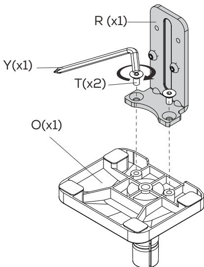
Monte a placa de fixação (R) na base (O) com os parafusos (T). Os parafusos podem ser apertados com a Chave Allen de 4mm (Y).
