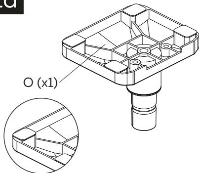
Verifique e certifique-se de que a vedação plástica na parte inferior da base (O) esteja corretamente encaixada no slot inferior.
