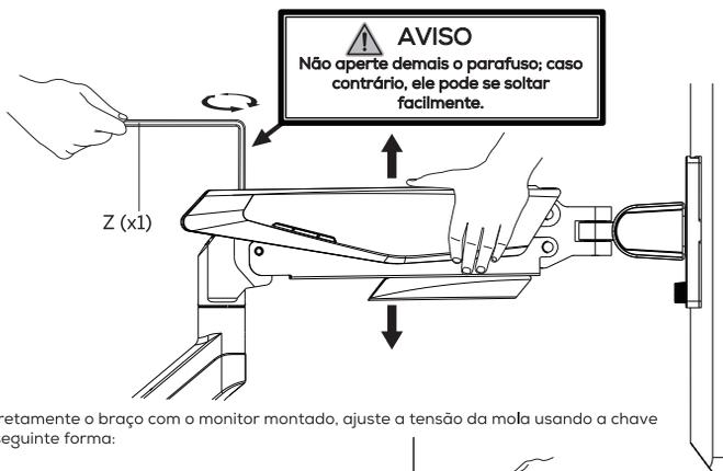
Para balancear corretamente o braço com o monitor montado, ajuste a tensão da mola usando a chave Allen fornecida da seguinte forma:
