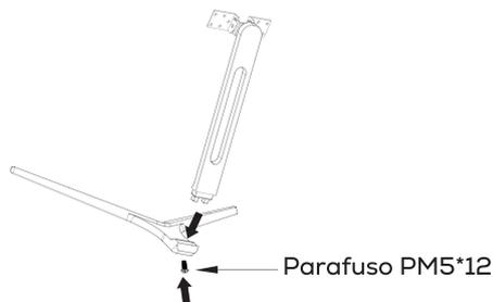
2- Ponha a tela do monitor para baixo no isopor e em seguida use 8 parafusos para prender a base de montagem nos orifícios de parafusos do monitor.
