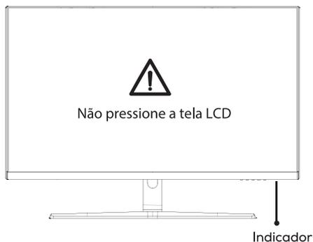
Indicador: A luz azul estável indica que a energia está conectada e que o monitor funciona normalmente. A luz vermelha estável indica que não há origem de vídeo e que nenhum sinal vertical e horizontal foi detectado ou que a tensão está fraca. Se assegure que o seu computador está ligado e que os cabos de sinal de vídeo estão todos devidamente plugados.
