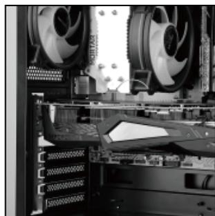
Posicione a placa de vídeo no Slot PCI-E da Placa-Mãe.
