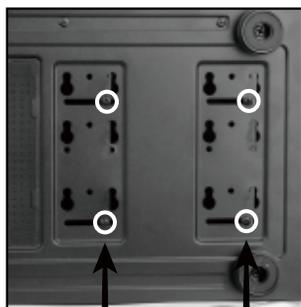
Remova os parafusos do suporte de HDD pela parte inferior do gabinete.
