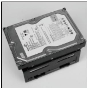
Posicione o HDD na parte superior do suporte, alinhando as furações com as do suporte.
