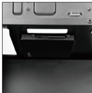
**Fixe o SSD com parafusos pela parte de fora da PSU Cover.**
