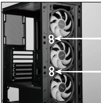
Fixe com os parafusos pela parte de fora do painel frontal.
