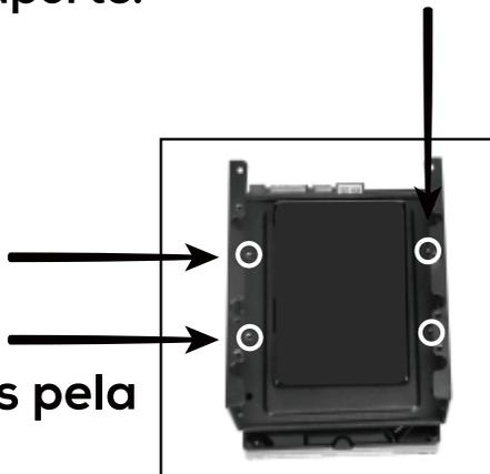
Fixe o HDD com parafusos pela parte interna do suporte.
