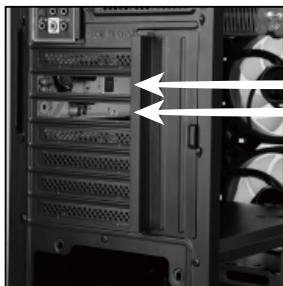
Remova os slots de expansão que serão utilizados, basta aplicar uma pequena força de dentro para fora do gabinete para destacar o slot de expansão.
