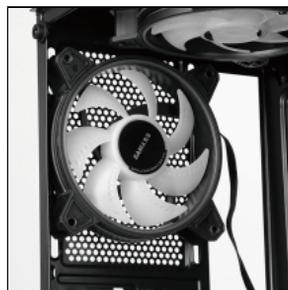
Fixe com os parafusos pela parte de fora do painel traseiro.
