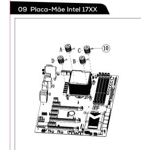
Instruções de Instalação: 1. Pasicion e monte a unidade de refrigeração liquida na CPU da placo-mãe conforme mestrado no diagrama. 2. Apôs alinhar os furos, apetre as porcas de montagem para a indicada até que não possam mais ser giradas.
