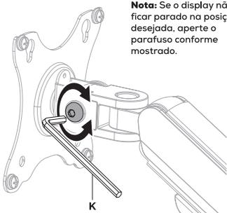
**Nota:** Se o display não ficar parado na posição desejada, aperte o parafuso conforme mostrado.
