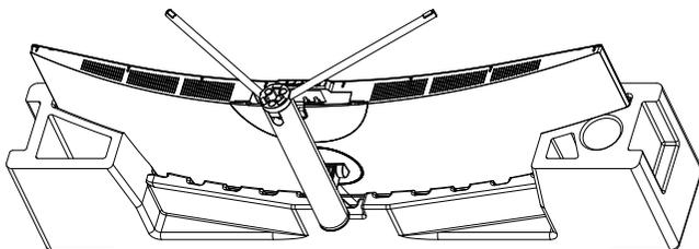
5. Ao remover a base, retire a tampa decorativa da parte traseira e puxe para baixo o botão de remoção rápida para remover a base.
