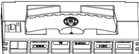
2. Insira a extremidade inferior do adaptador de parede no slot do invólucro traseiro e, em seguida, bata no adaptador manualmente nos dois slots na extremidade superior.
