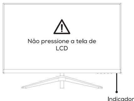
Indicador: A luz azul estável indica que a energia está conectada e que o monitor funciona normalmente. A luz vermelha estável indica que não há origem de vídeo e que nenhum sinal vertical e horizontal foi detectado ou que a tensão está fraca. Se assegure que o seu computador está ligado e que os cabos de sinal de vídeo estão todos devidamente plugados.
