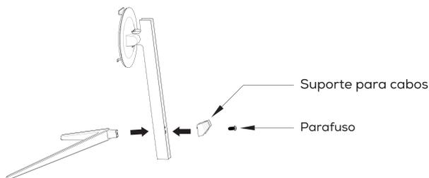
2- Retire o monitor da embalagem, mantenha o monitor em posição estável e com a tela para cima, prenda o suporte no monitor, empurre-os rapidamente e solte o botão para completar a montagem do suporte do monitor.
