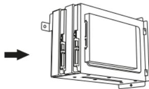
Dentro do suporte, até dois HDs de 3,5" podem ser fixados através de parafusos na parte lateral.
