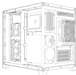
Remova a lateral de metal do gabinete. A posição de instalação da fonte fica na parte inferior, com a fonte na orientação vertical
