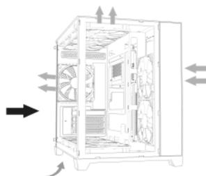
Referência para instalação e orientação do fluxo de ar
