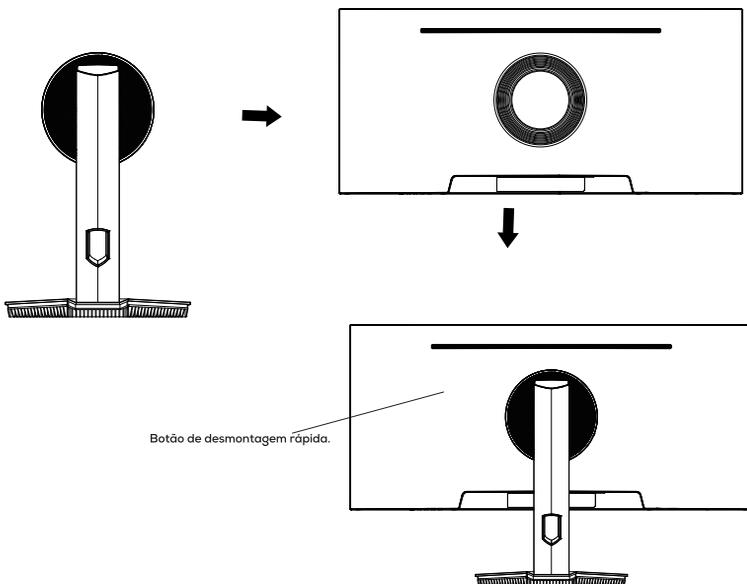
1. O pino de ferro encontrado na bolsa de acessórios pode ser travado na furação M4 do case traseiro, conforme mostrado na figura abaixo, e travado com uma chave de fenda de ponta chata.
