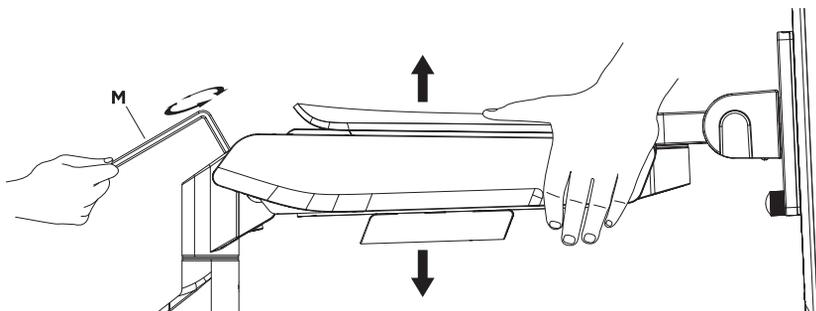
Primeiro, posicione e segure firmemente o braço horizontalmente, conforme mostrado.
