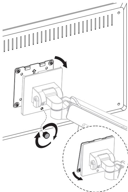
Para equilibrar adequadamente o braço com o monitor montado, ajuste a tensão da mola usando a chave Allen fornecida da seguinte forma:
