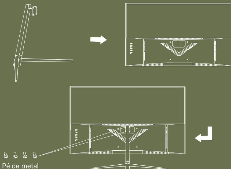
3. Se desejar remover a base, remova a tampa decorativa da parte traseira e utilize uma chave de fenda para desapertar os parafusos. Manuseie com cuidado e evite aplicar força excessiva.
