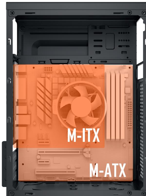
**Posicione a Placa-Mãe alinhando suas furações com as do gabinete, reposicione os espaçadores se necessário, e fixe com os respectivos parafusos.**
