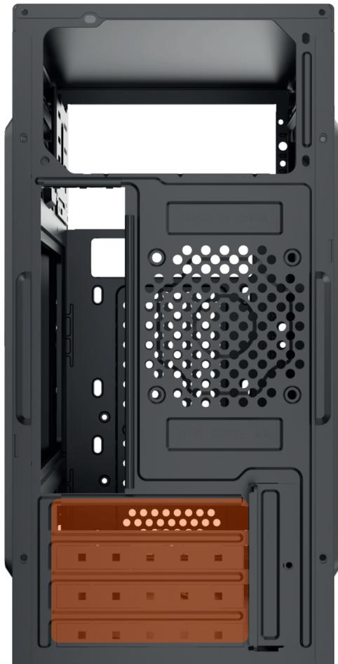
Identifique e remova os slots de expansão que o modelo da Placa de Vídeo irá utilizar, instale a Placa de Vídeo na Placa-Mãe, e fixe com os respectivos parafusos pela parte traseira do gabinete.
