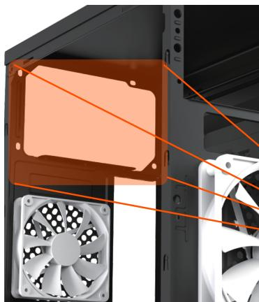
Remova as laterais do gabinete para ter acesso ao local de instalação, posicione a Fonte de Alimentação alinhando suas furações com o local de instalação, e fixe com os respectivos parafusos pela parte traseira do gabinete.
