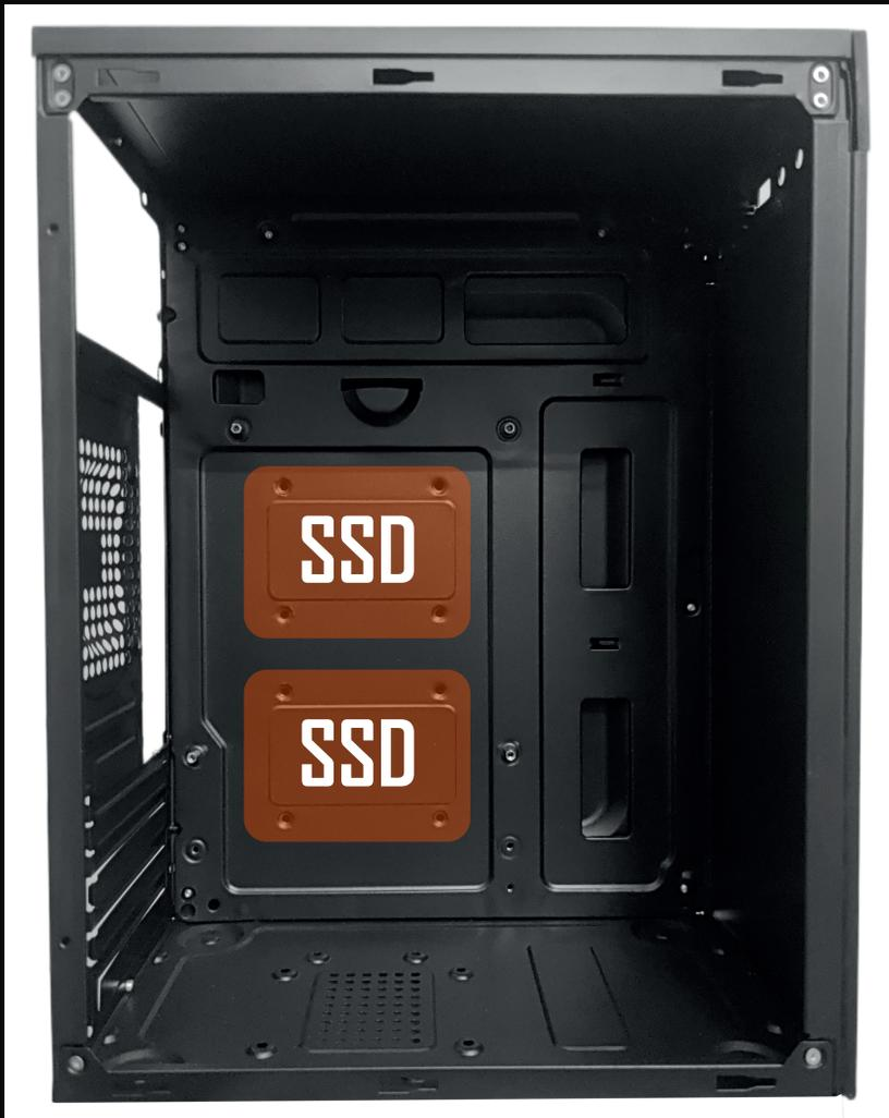
Remova as laterais para ter acesso ao local de instalação do SSD, posicione o SSD alinhando suas furações com as do local, e fixe com os respectivos parafusos.
