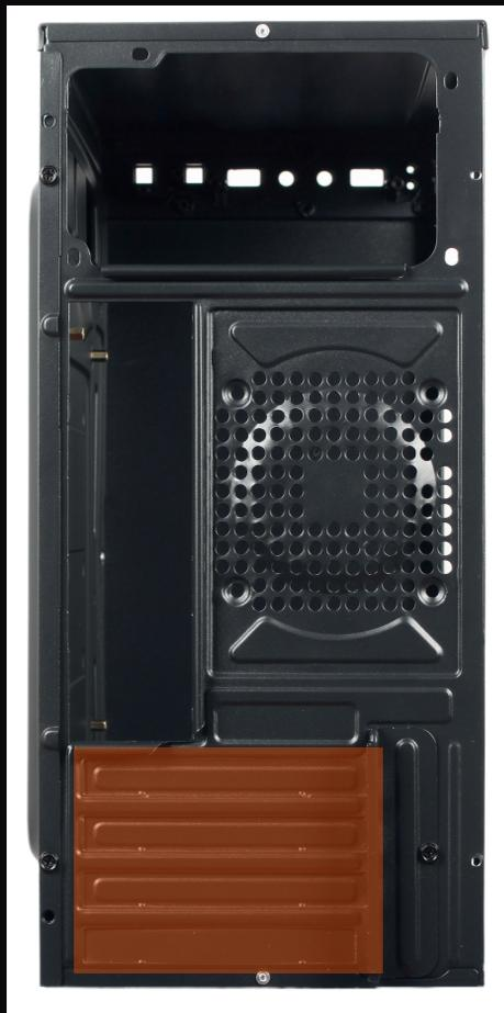
**Identifique e remova os slots de expansão que o modelo da Placa de Vídeo irá utilizar, instale a Placa de Vídeo na Placa-Mãe, e fixe com os respectivos parafusos pela parte traseira do gabinete.**
