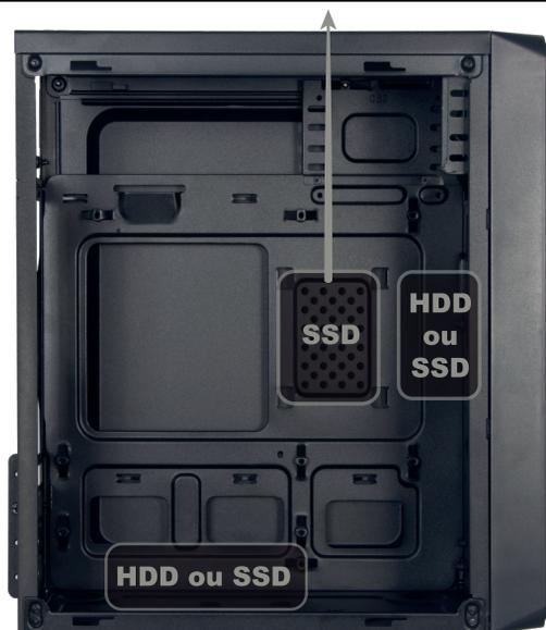
Posicione o HDD/SSD alinhando suas furações com as do local de instalação, e fixe com os respectivos parafusos.
