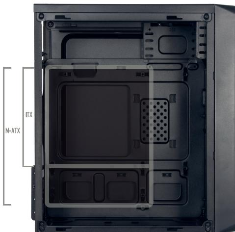
Posicione a Placa-Mãe alinhando suas furações com as do local de instalação, reposicione os espaçadores se necessário, e fixe com os respectivos parafusos.
