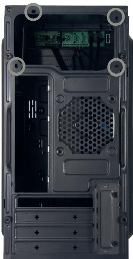
Remova as laterais para ter acesso ao local de instalação, posicione a Fonte de Alimentação alinhando suas furações com o local de instalação, e fixe com os respectivos parafusos pela parte traseira do gabinete.
