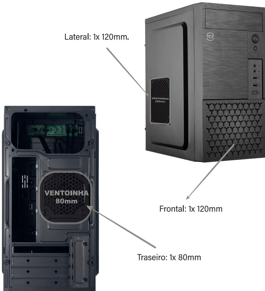
Posicione a Ventoinha/Water Cooler alinhando suas furações com a do local de instalação, e fixe com os respectivos parafusos.
