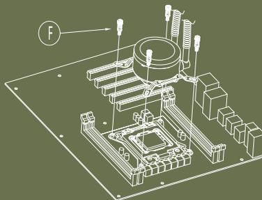
Aplique uniformemente a pasta térmica na superfície da CPU e instale a bomba na placa-mãe.
