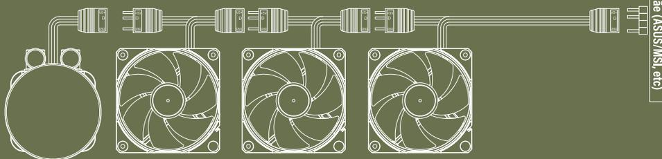
Por favor, conecte todos os conectores ARGB conforme mostrado na imagem. Se a placa-mãe não estiver configurada com nenhum efeito de luz, a iluminação será automaticamente RGB fluente. Após configurar o efeito de iluminação na placa-mãe, a iluminação será sincronizada com a placa-mãe. (Se a placa-mãe não estiver configurada com nenhum efeito de luz, só é possível conectar no máximo 3 ventoinhas. Se houver mais de 3 ventoinhas, pode causar uma luz anormal).
