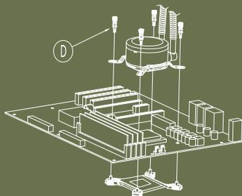
Instale a placa traseira no soquete correspondente na placa-mãe e instale a bomba sobre a placa traseira.
