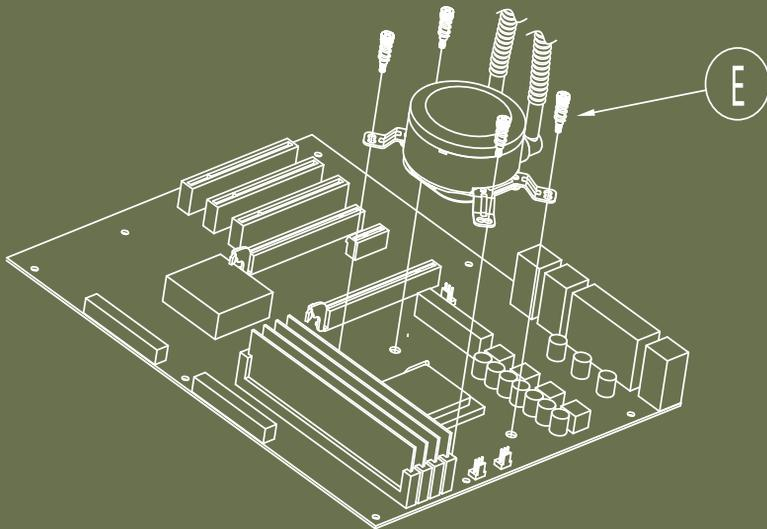
Para AM3/AM4, é necessário remover o gancho da placa-mãe AMD e manter a placa traseira original da placa-mãe, depois instalar a bomba na placa traseira original da placa-mãe. Para AM5, pode ser instalado diretamente na placa-mãe.
