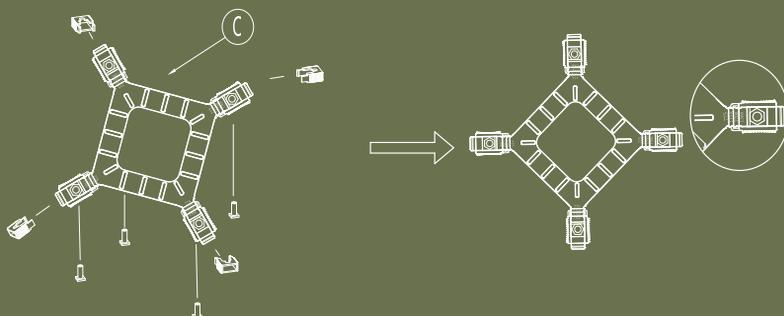
Ajuste os quatro slots do Suporte de Montagem Intel para as posições correspondentes de acordo com o soquete da placa-mãe.
