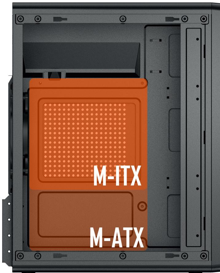
**Posicione a Placa-Mãe alinhando suas furações com as do gabinete, reposicione os espaçadores se necessário, e fixe com os respectivos parafusos.**
