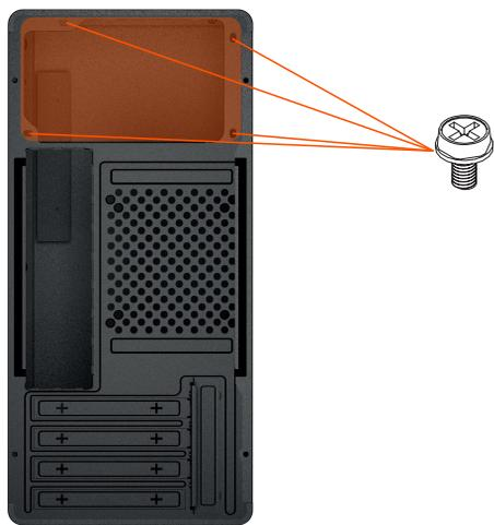
Remova as laterais do gabinete para ter acesso ao local de instalação, posicione a Fonte de Alimentação alinhando suas furações com o local de instalação, e fixe com os respectivos parafusos pela parte traseira do gabinete.
