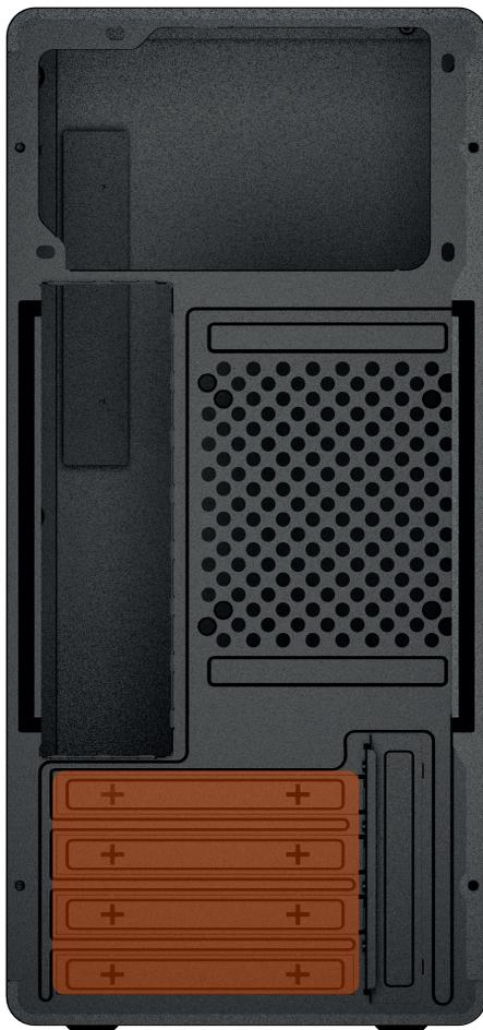
Identifique e remova os slots de expansão que o modelo da Placa de Vídeo irá utilizar, instale a Placa de Vídeo na Placa-Mãe, e fixe com os respectivos parafusos pela parte traseira do gabinete.
