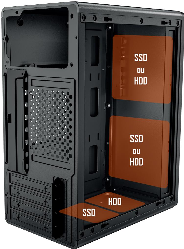
Remova as laterais para ter acesso ao local de instalação do SSD/HDD, posicione o SSD/HDD alinhando suas furações com as do local, e fixe com os respectivos parafusos.
